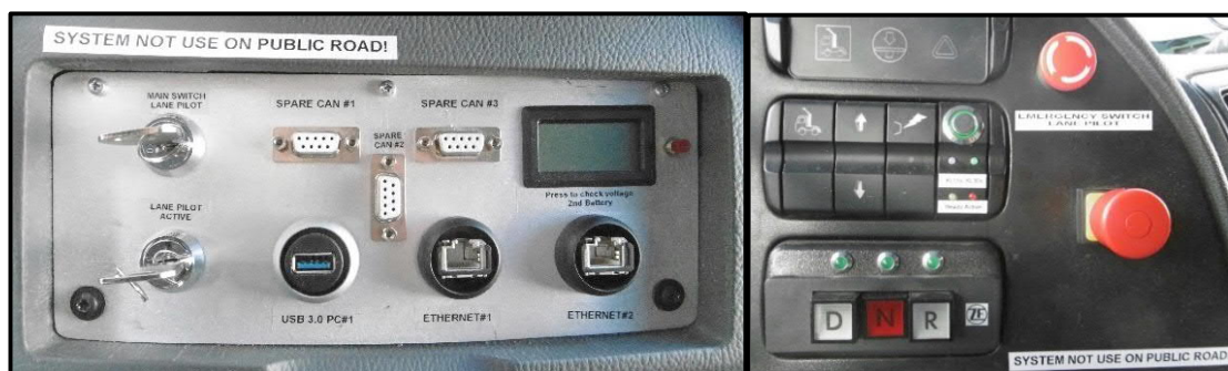
Abbildung 30: Control board des HAD (highly automated driving) systems von IAV und Bedienelemente im Versuchsträger Actros #1
