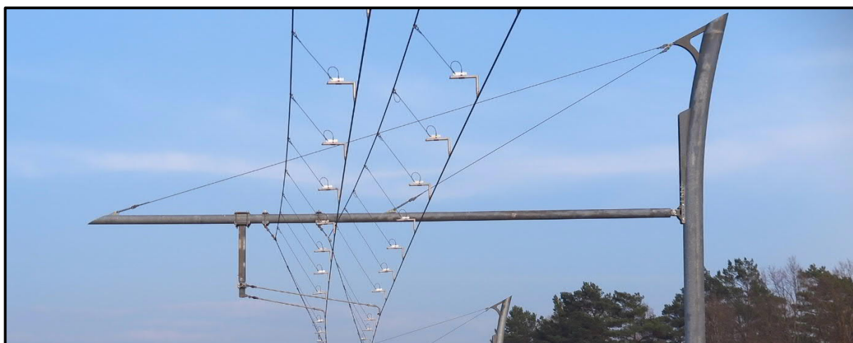
Abbildung 8: Probearbeit am Versuchsaufbau der neu entwickelten Klemmen und Seitenhalter auf der Versuchsanlage in Groß Dölln
