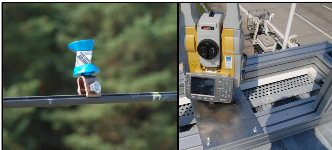
Abbildung 42: Windabtriebsmessung - Messprisma (links) / Tachymeter (rechts)
