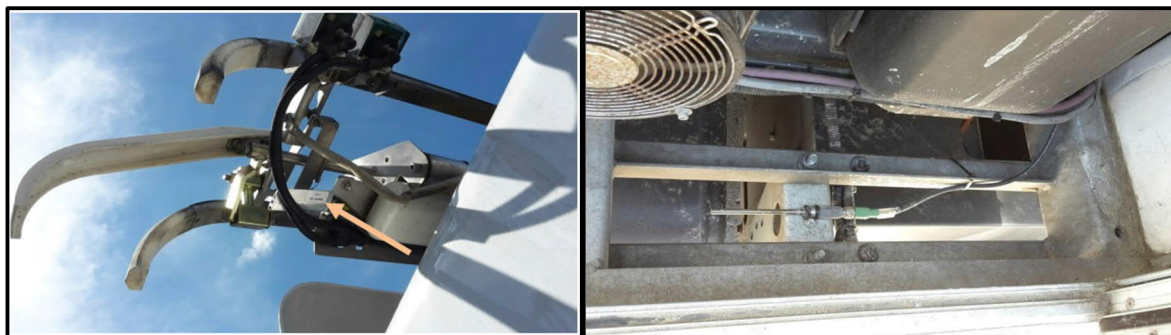
Abbildung 70: Einbauposition von Wind- und Temperatursensoren
