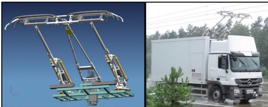
Abbildung 2: Lkw-Stromabnehmer der ersten Generation im Projekt ENUBA [13]
