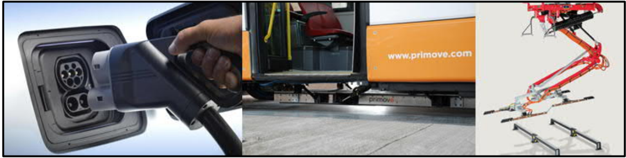
Abbildung 23: Verschiedene Ladesysteme für OH-Lkw Plug-In, Induktiv, Pantograph
