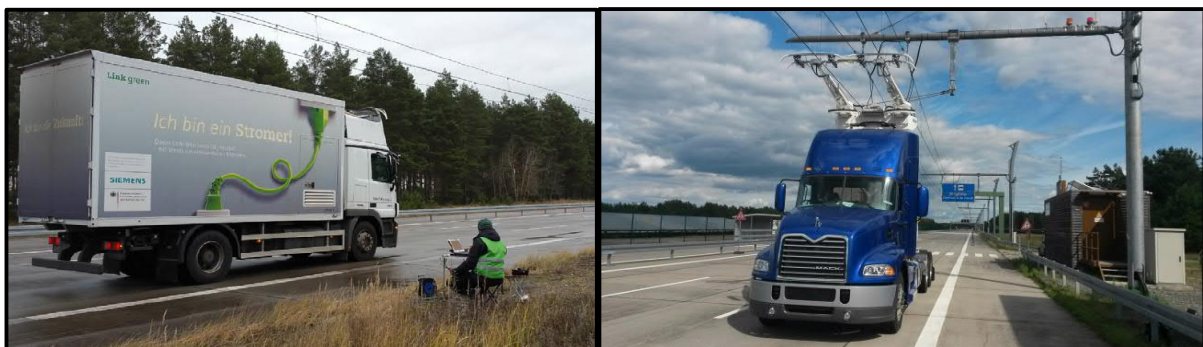
Abbildung 92: Messung des Standgeräusches (Diesel) des Lkw „Actros #2 (links) / des Vorbeifahrtgeräusches angebügelt des Volvo-Lkw „Mack“ rechts)
