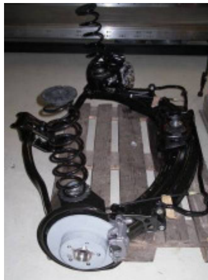
Abbildung 11: Realisierte Hinterachse für den Demonstrator 1 (CAD-Konstruktion und Realisierung in Hardware)
