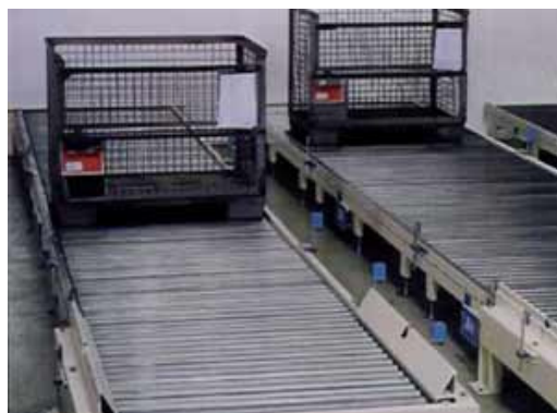
Abbildung 27: Detailansicht von Rollenbahnanwendungen von HaRo - Quelle: www.HaRo-Gruppe.de
