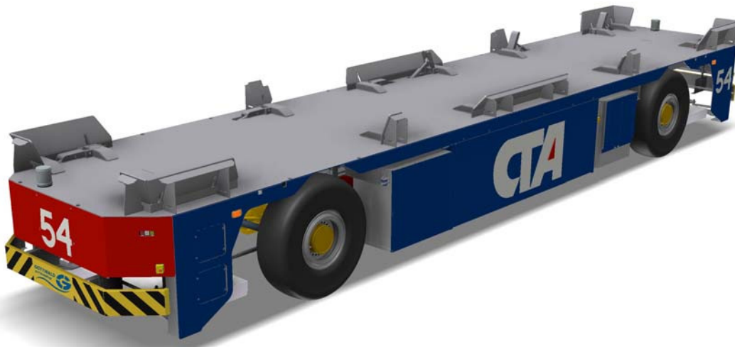
Abbildung 6: CAD-Modell des Batterie-AGV
