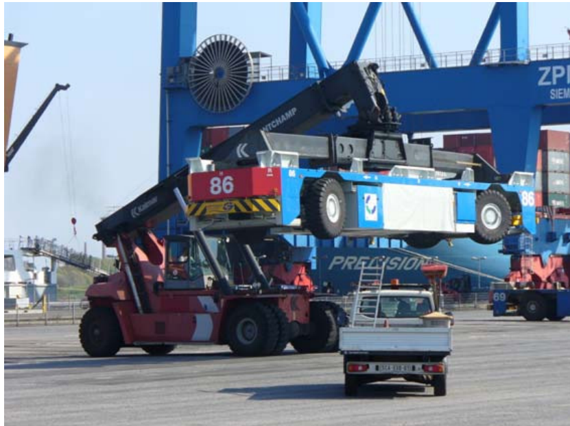
Abbildung 32: Erprobung des Bergevorgang mittels Reach-Stacker
