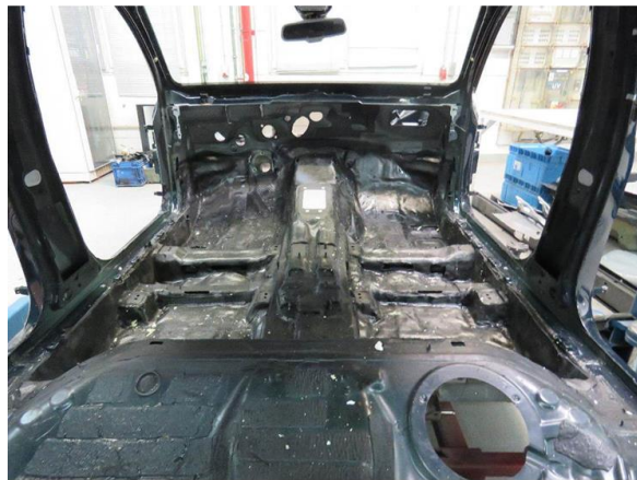
CFK Inlay innerhalb der Fahrgastzelle
