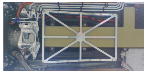
Schubfeld unter Tunnelbatterie
