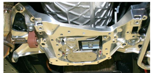
Getriebekonsolle mit erweiterten Anbindungspunkten
