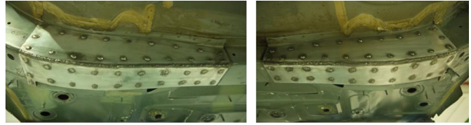
Patches auf den Längsträgern im Bereich des Vorderwagens
