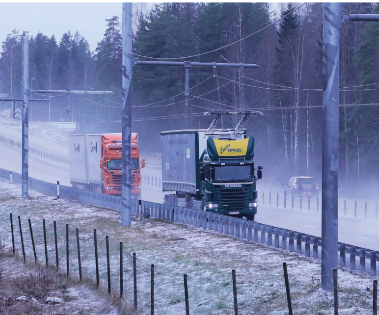
Ein eLKW im Straßenbetrieb auf einem eHighway in Schweden.
