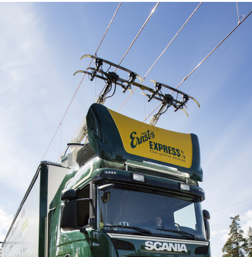
Ein eLKW mit Pantograph an der Oberleitung.
