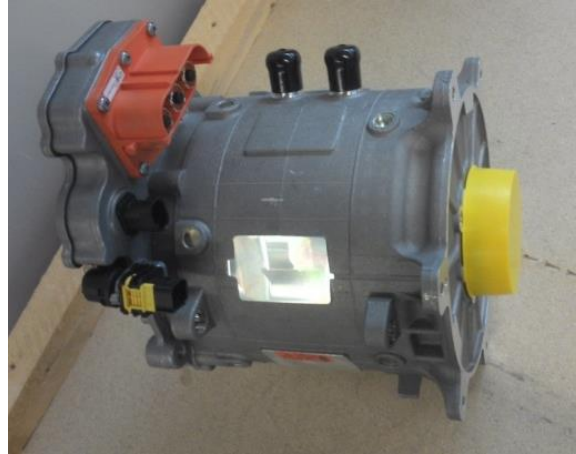
Abbildung 36: Permanentmagneterregte Synchronmaschine (PMSM) der Fa. Bosch
