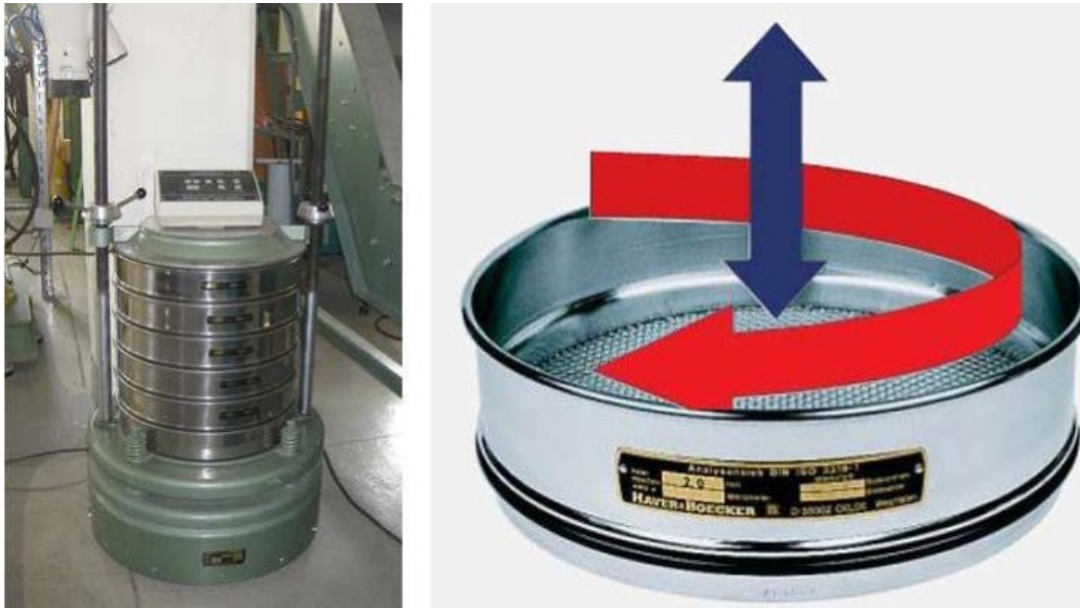
Abbildung 63: Analysensiebmaschine Haver & Boecker EML-400T (links: Gesamtansicht der Analysensiebmaschine im MVT-Technikum; rechts: 3D-Siebbewegung auf dem Siebboden [nach H&B- Prospekt])
