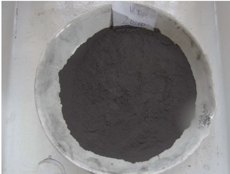
Abbildung 69: Typisches Aktive Masseprodukt < 200 µm der mittels TYP I erzeugten Zerkleinerungsprodukte (aus V4)
