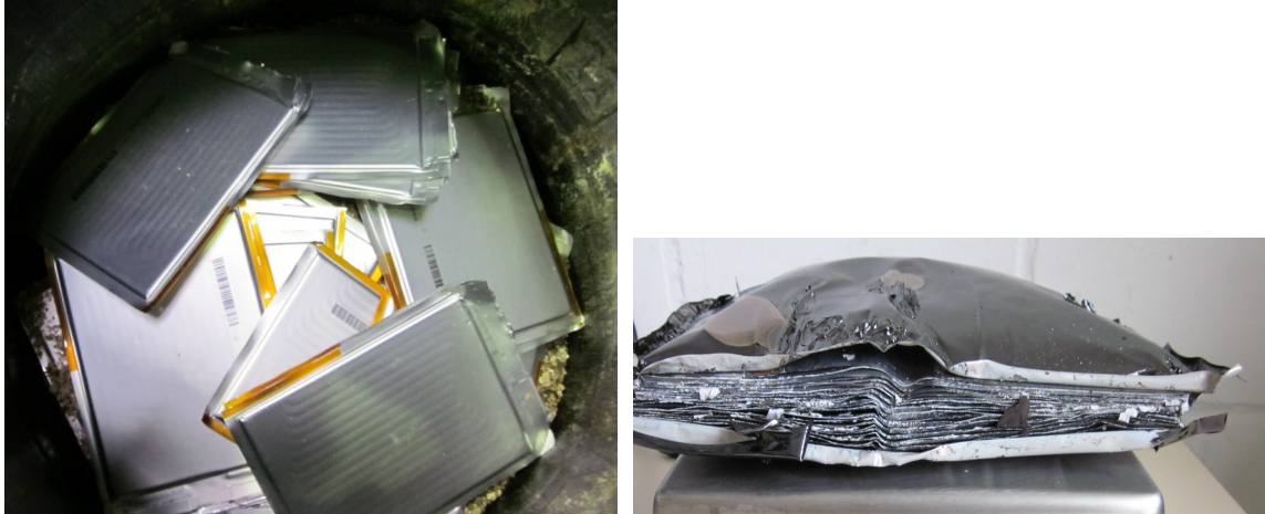
Abbildung 52: Pouch-Zellen vor und nach thermischer Behandlung
