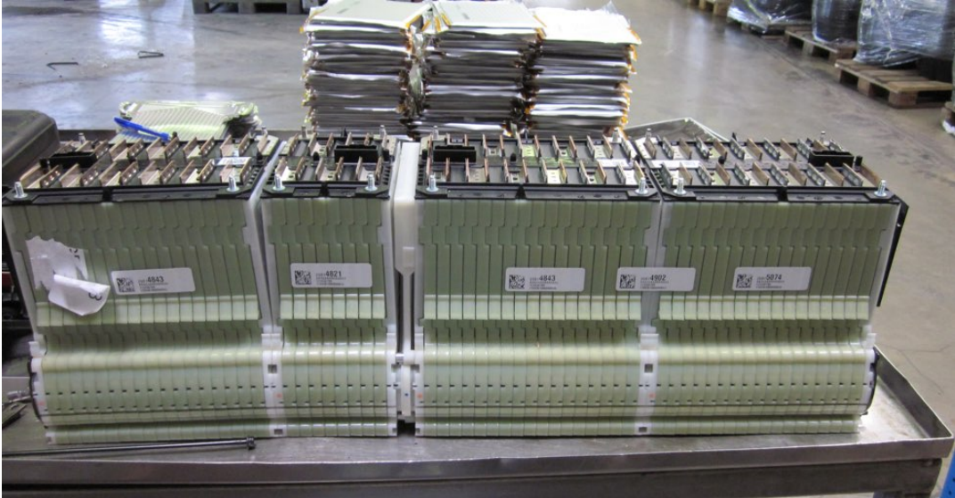
Abbildung 17: Batteriemodul vor der Demontage
