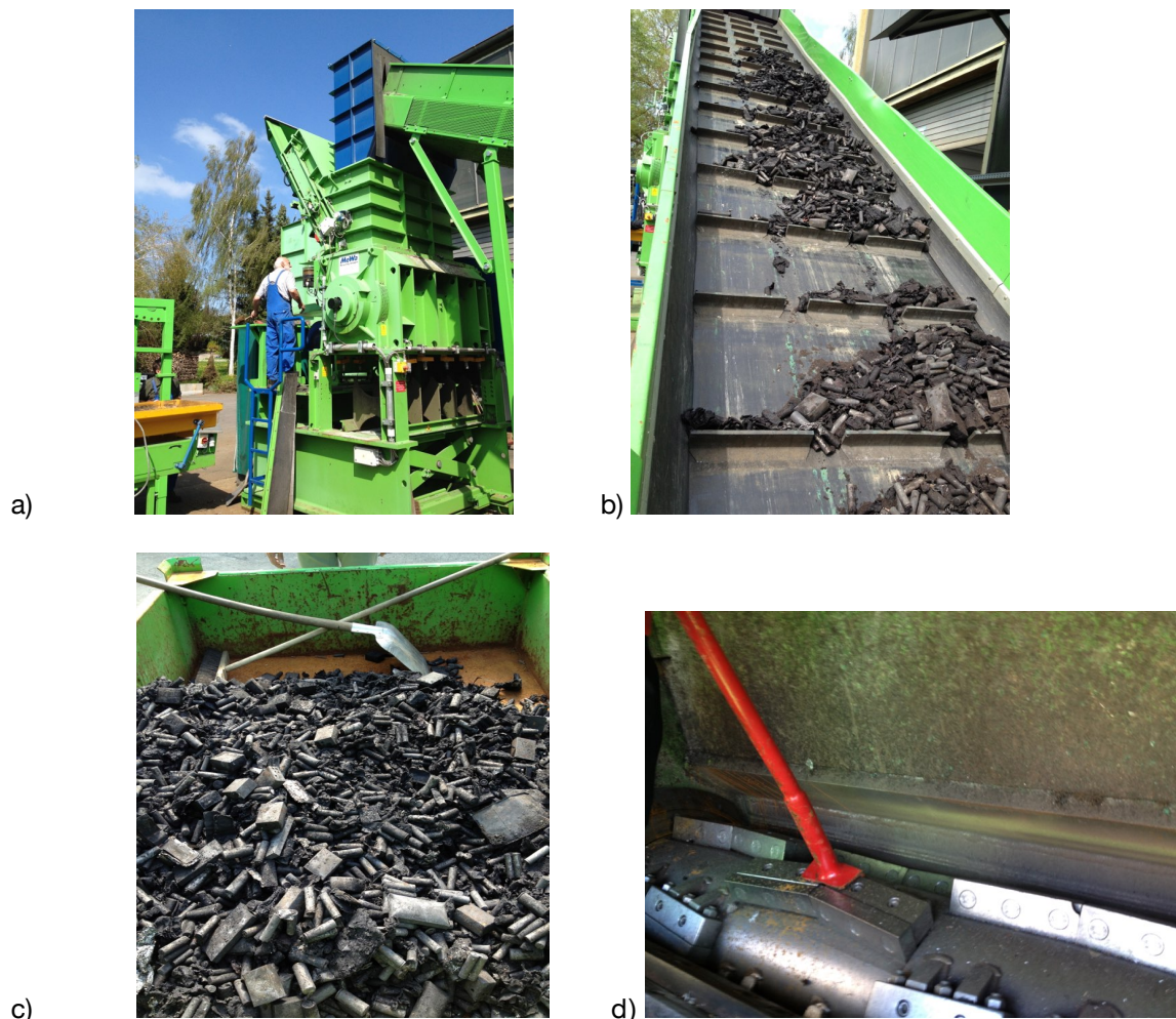
Abbildung 72: a) Granulator Typ IIX, b) Zuführband, c) Fülltrichter, d) Rotorraum
