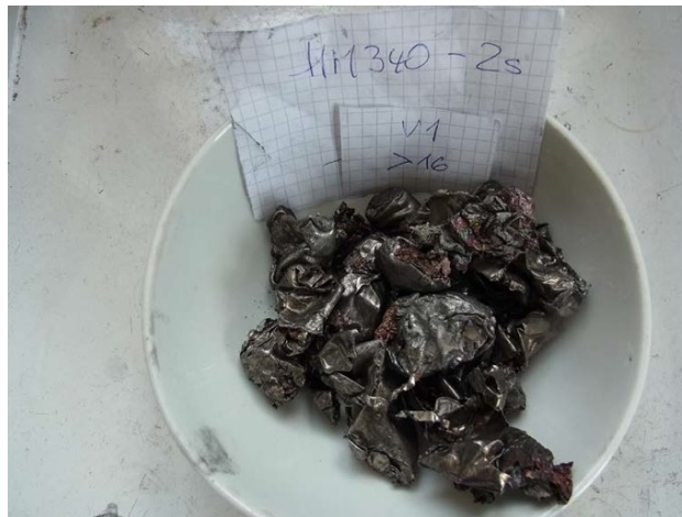
Abbildung 65: Partikelgrößenverteilungen der Zerkleinerungsprodukte aus Laborhammermühle Typ I bzw. Granulator Typ II mit Kennzeichnung der Produktqualitäten
