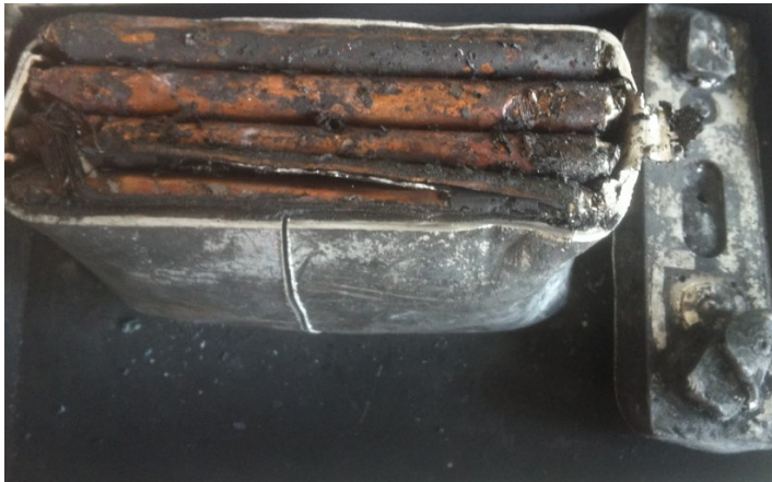
Abbildung 53: prismaticen Hardcase-Zellen nach thermischer Behandlung
