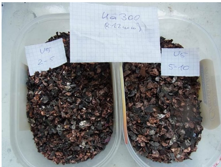
Abbildung 70: Typisches Al/Cu-Elektrodenprodukt 2/5 bzw. 5/10 mm der mittels Granulator TYP II und 12 mm-Rost zerkleinerten pyrolysierten Li-Akkus (V5)
