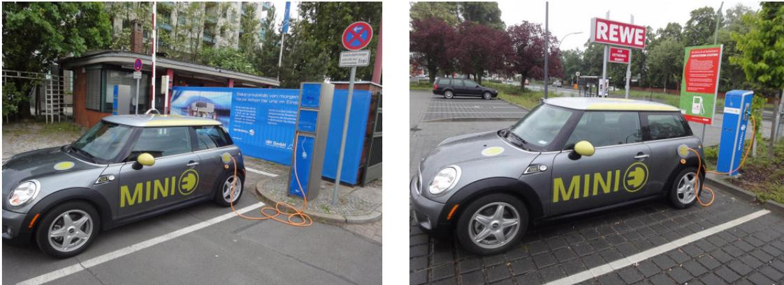
**Abbildung 19 Ladestationen alten Typs (links) und neuen Typs (rechts)<sup>4</sup>**
